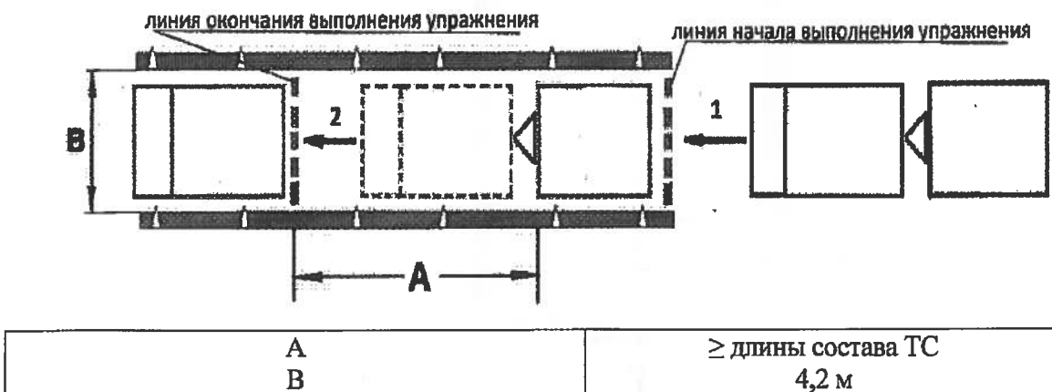
Рисунок 15. Схема и размеры элемента упражнения № 9 - «Расцепление прицепа с тягачом»
